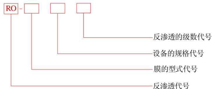
4.2.2 反渗透膜的型式代号(用汉语拼音字头表示):
